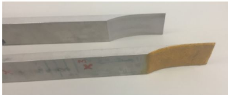
Hình 13: Thanh nhôm "lỗ đen" có lớp hấp thụ năng lượng sóng (màu vàng) tại phần đuôi và thanh kia không có [14].
